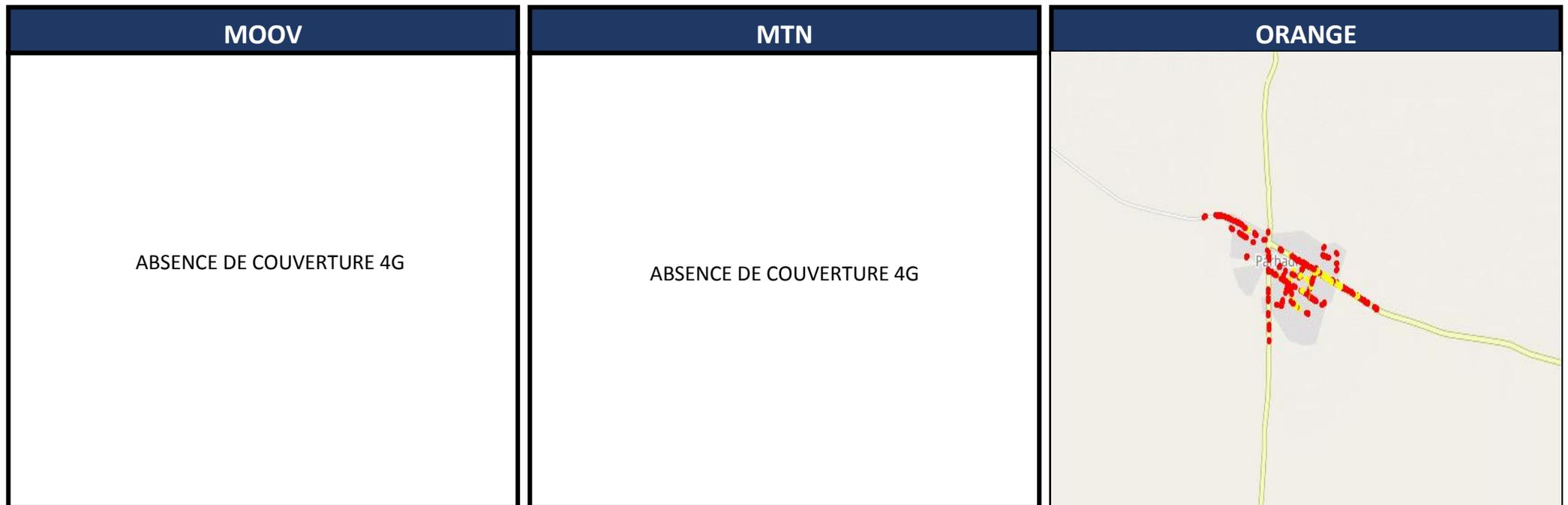
L'opérateur ORANGE est le seul opérateur qui dispose du niveau de champs pour la technologie 4G avec un taux de fiabilité de 32,56%. Des dispositions doivent être prises par les opérateurs MOOV, MTN et ORANGE pour apporter une bonne couverture radio électrique pour la technologie 4G dans la localité.
