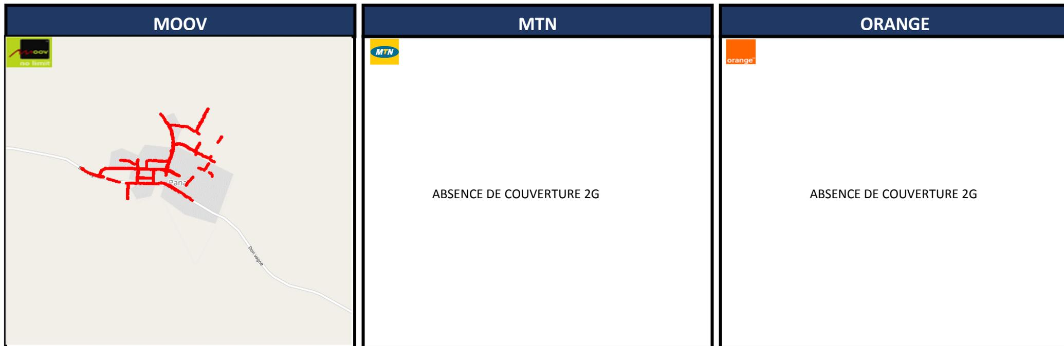
Les opérateurs MTN et ORANGE ne disposent pas de la couverture radio électrique 2G dans la localité de KPANAN et doivent donc prendre des mesures pour couvrir la localité en 2G. Par conséquent, l'audit du niveau de champs 2G s'est effectué uniquement pour l'opérateur MOOV.
