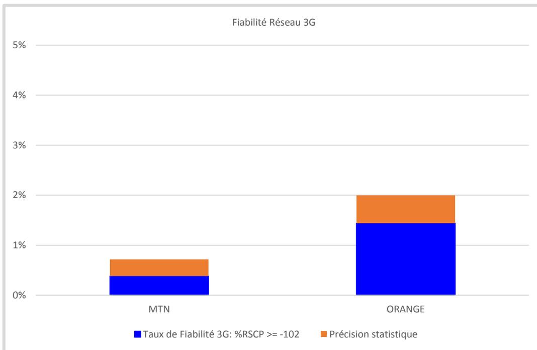
La couverture radio électrique pour la technologie 3G dans la localité est assurée par les opérateurs MTN et ORANGE, avec des taux de fiabilité respectifs de 0,38% et 1,44%. On observe une couverture quasi inexistante dans la localité. L'opérateur MOOV par contre ne couvre pas la localité en 3G.
