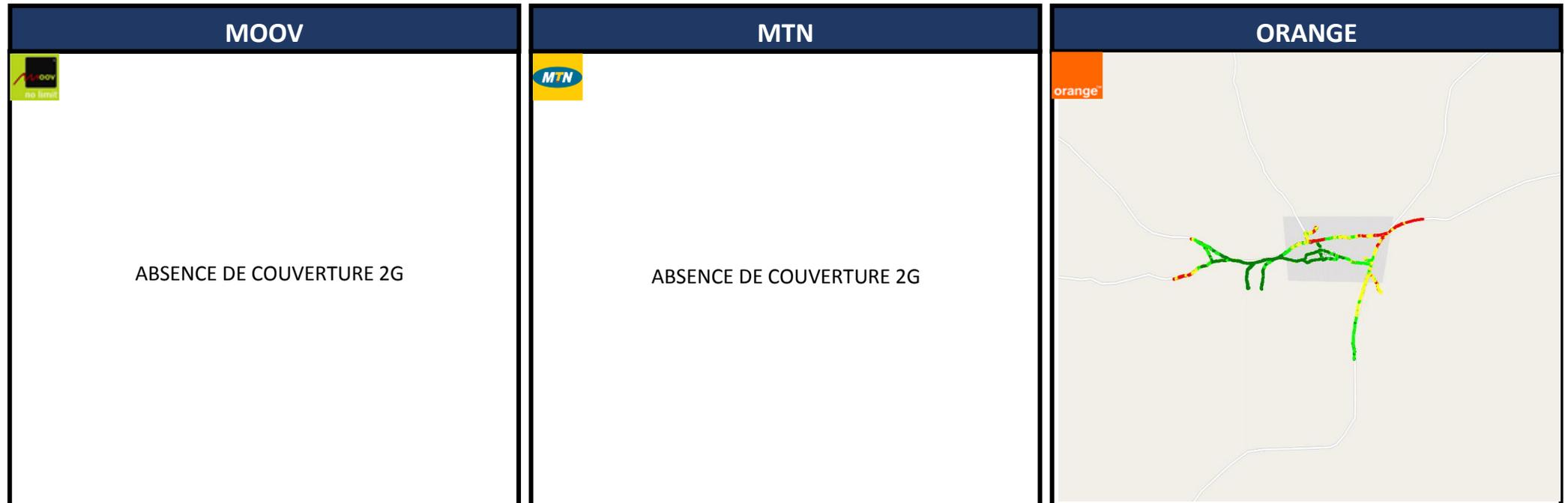
L'opérateur ORANGE est le seul opérateur qui dispose du niveau de champs pour la technologie 2G. Des dispositions doivent être prises par les opérateurs MOOV et MTN pour apporter une bonne couverture radio 2G dans la localité.
