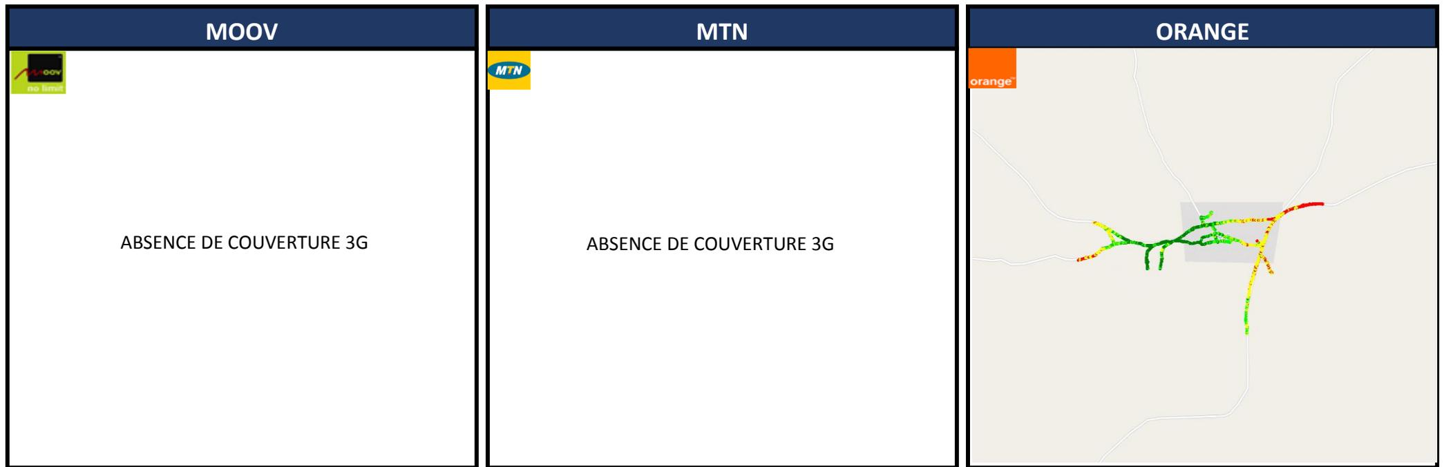
L'opérateur ORANGE est le seul opérateur qui dispose du niveau de champs pour la technologie 3G. Des dispositions doivent être prises par les opérateurs MOOV et MTN pour apporter une couverture radio 3G dans la localité.
