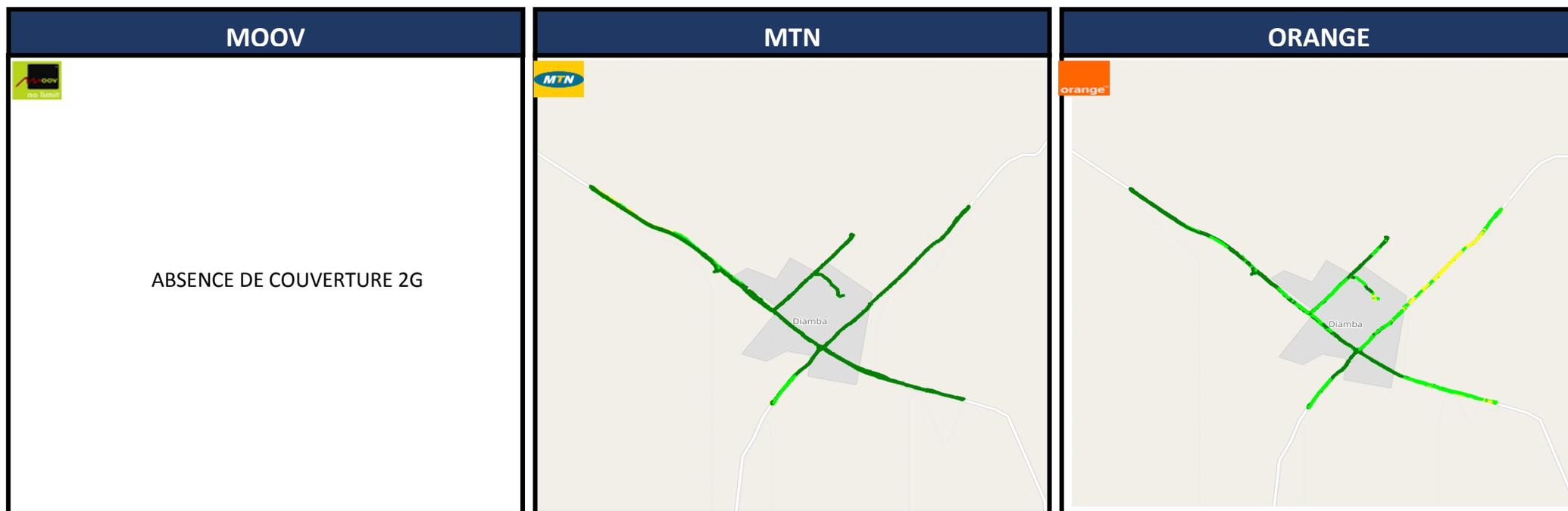
L'opérateur MOOV ne couvre pas la localité de DIAMBA en 2G. L'audit s'est effectué sur les réseaux des opérateurs MTN et ORANGE qui ont un niveau de champs dans la technologie 2G.
