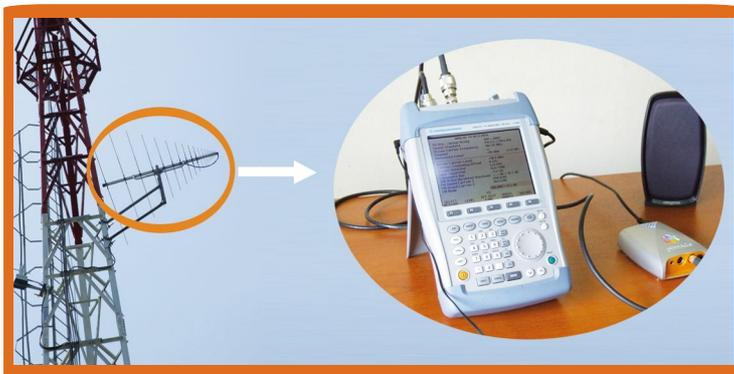
L'analyseur de spectre FSH3 est un équipement doté d'une technologie de pointe, il permet à l'ATCI de réaliser des mesures sur les signaux télévisuels aux fins de régler l'utilisation du spectre de fréquences attribuées à ce service et de résoudre les différents phénomènes de brouillages en audiovisuel. Sa plage de mesure est de 100kHz-3GHz.
