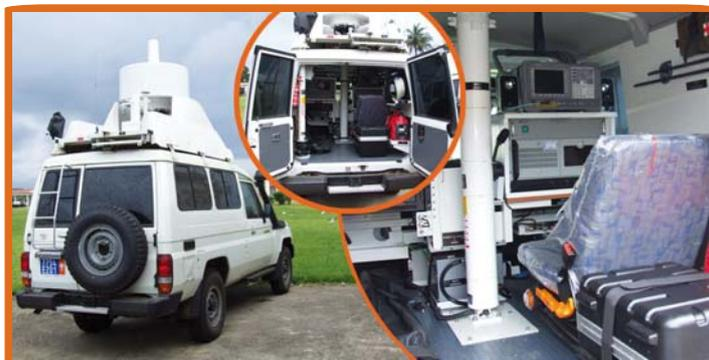
Dans le cadre de sa mission de contrôle du spectre de fréquences radioélectriques, l'ATCI dispose d'un système composé de stations fixes (FMS : Fix Monitoring Station) et de stations mobiles dénommées « Mobile Monitoring Station », en abrégé MMS.
