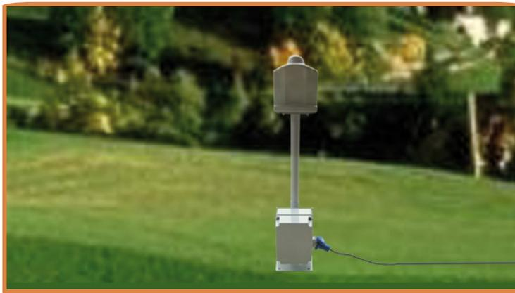
Pour pouvoir mesurer de façon permanente, l'exposition des personnes aux champs électromagnétiques émis par les antennes des sociétés de téléphonie et rendre ces informations accessibles (dans un proche avenir) aux riverains via Internet, l'ATCI dispose d'un système de mesure sélective et en continu du champ électromagnétique, dénommé « **Insite Box** ».
