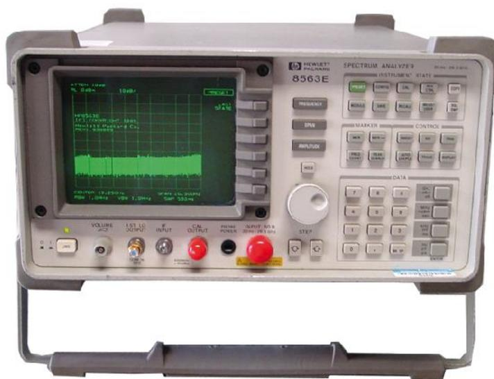
Un analyseur de spectre est un instrument de mesure, qui permet de visualiser les différentes fréquences contenues dans un signal ainsi que leurs amplitudes respectives. Les signaux peuvent être de natures diverses : électrique, optique, sonore, radioélectrique.
